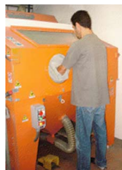
Slutet kretslopp med vakuumsystem, en process med ett komplett system och undertryck. Operatören är inte i kontakt med sanden.
